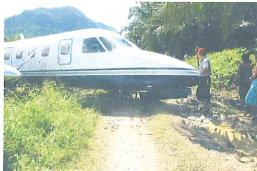
Compuertas compartimiento del Patín de nariz, daños menores.
