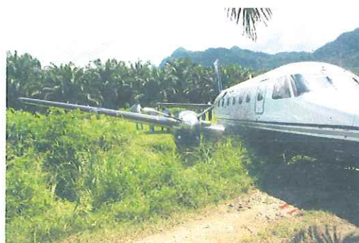
Daño en las hélices al golpear contra la orilla de la pista.
