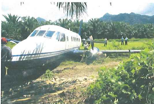
Daño en las hélices al golpear contra la orilla de la pista.
